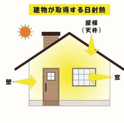
※外皮等の面積(m<sup>2</sup>)=屋根(天井)面積+外壁面積+床面積+窓等(開口部)面積+土間床面積
